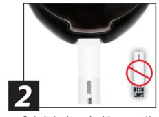
Retire la tira de prueba del envase y ciérrelo de inmediato. Inserte el extremo con los contactos de la tira de prueba (los bloques hacia arriba) en el puerto de prueba. El medidor se activa.
